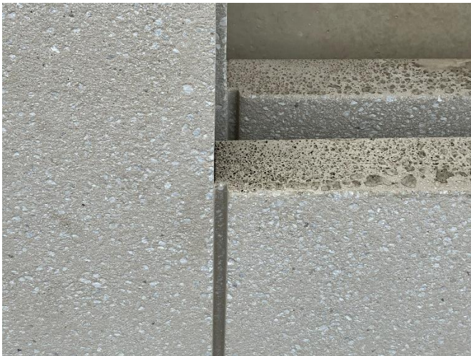
Bild: Vorderseite eines Betonfertigteils mit der finalen Oberflächenstruktur (gestrahlt), Quelle Fraunhofer IBP
